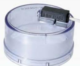
I tentativi di frode dei dispositivi lanciaimpulsi consistono nell'utilizzo di magneti esterni che, avvicinati ai dispositivi stessi, alterano il corretto funzionamento del contatto elettrico. B METERS, su richiesta, fornisce dispositivi lanciaimpulsi dotati di un ulteriore contatto REED che, all'approssimarsi di una forza magnetica esterna, genera un segnale di allarme.
