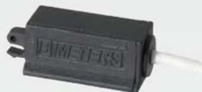
I contatori dotati di dispositivo lancia impulsi possono essere collegati a sistemi di tele-lettura, PLC, reti M-Bus (abbinati a convertitori di segnale PADPULSE), totalizzatori e in tutte quelle applicazioni che necessitano della lettura da remoto dei dati di consumo rilevati dal contatore d'acqua. I contatori possono essere acquistati completi di dispositivo lanciaimpulsi o con predisposizione per il successivo montaggio del dispositivo.
